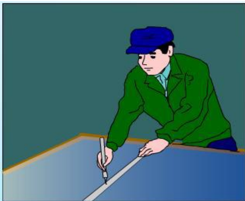
玻璃刀上的金刚石可以裁玻璃
