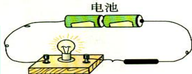
图 6-8 石墨导电实验
