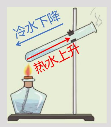
加热试管下端的水,下端的冷水受热后向上方流动,上方的冷水向下方流动,水的各部分发生相对运动,即发生了热对流现象。
